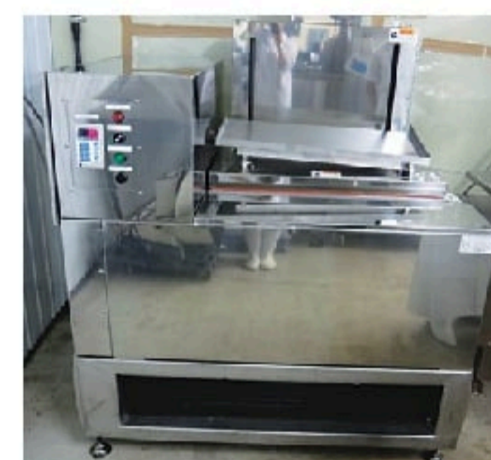
当事業で導入した液体急速凍結器
