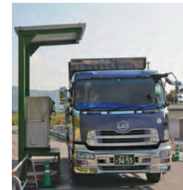
製品の積み込みを終えた車両は退場する際、計量時にカードを読み込ませ、出荷計量伝票が自動で発行される
