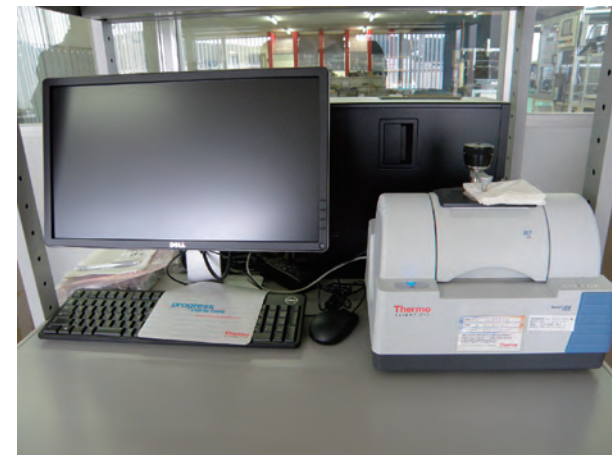
FT-IRによるフッ素樹脂の表面分析を行う赤外分光光度計
