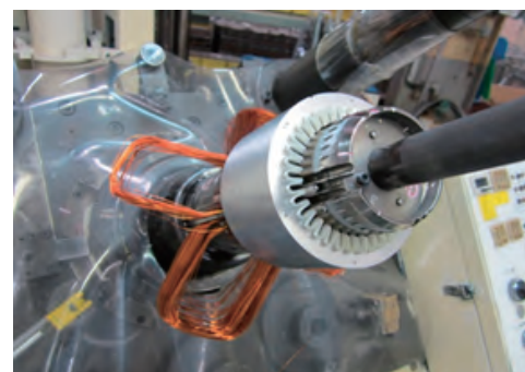
導入した巻線挿入機で鉄心に巻線を挿入する直前
