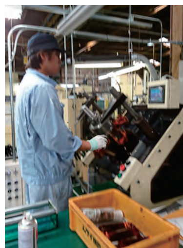
巻線挿入機の作業風景
