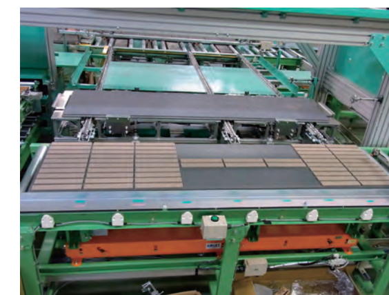
移載機による実際のタイル貼り付け結果
