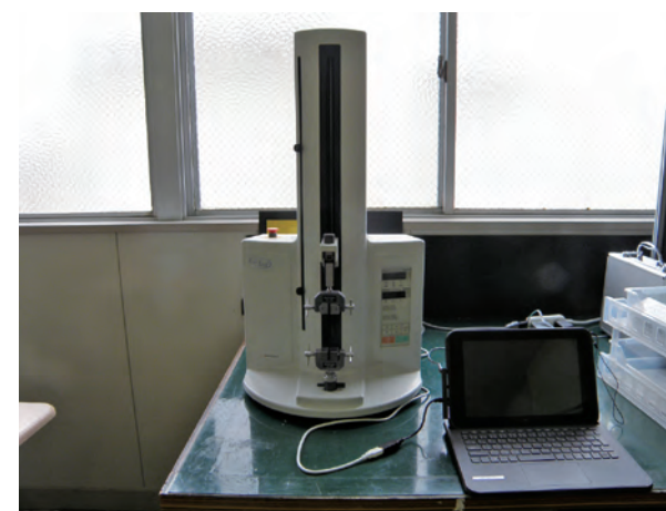
剥離力を測定する引張試験機
