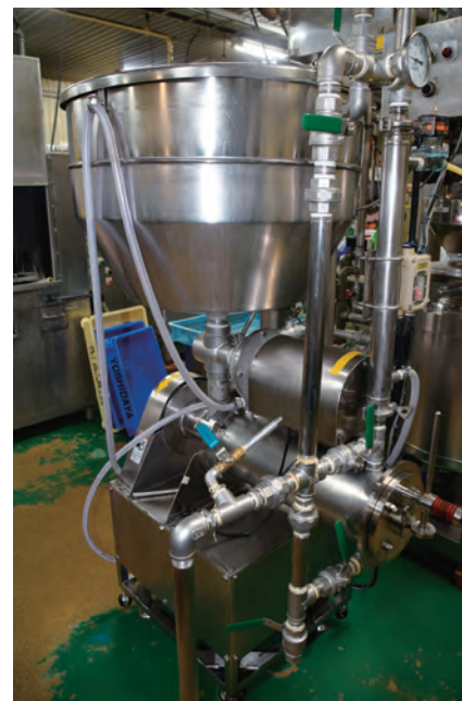
補助金を活用して導入した高濃度豆乳抽出機械②
