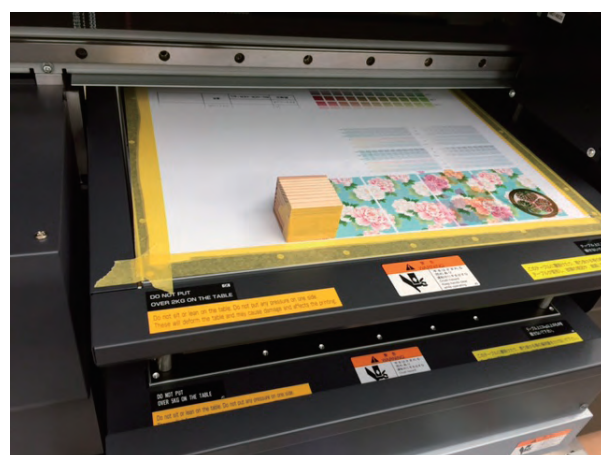
高さのある箱の蓋上部への印刷を検証
