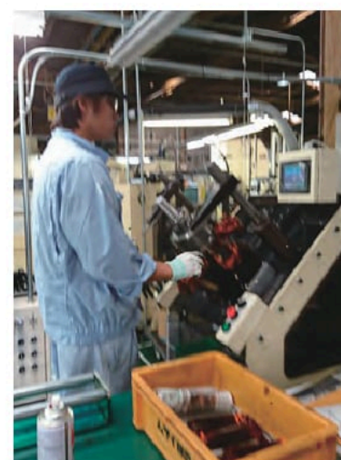
巻線挿入機の作業風景
