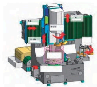
φ300まで加工可能な高性能内径研削盤の全体図
