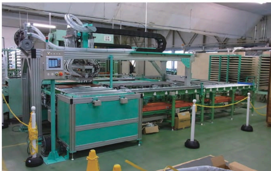
オリジナルで開発した タイル移載・貼り付け装置
