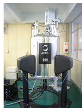
超伝導核磁気共鳴装置マグネット部分
