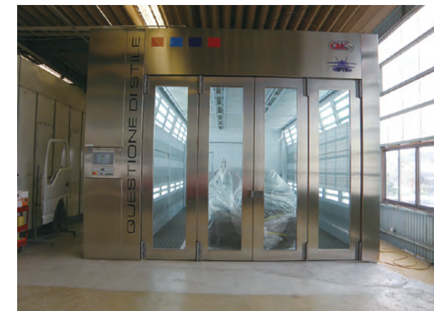
水性塗料専用の塗装・乾燥設備
