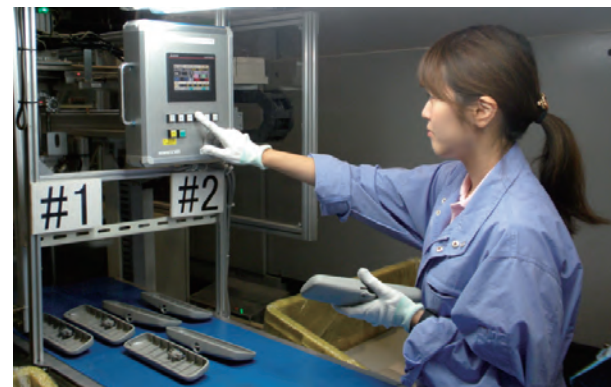
製品検査結果のIoTへの入力
