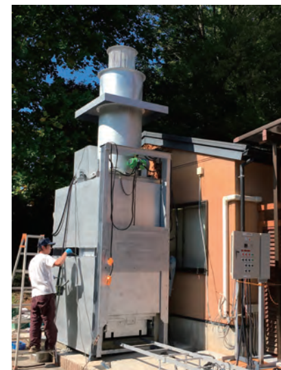
50kgを超える大型犬などにも対応できる新たに導入したペット火葬炉
