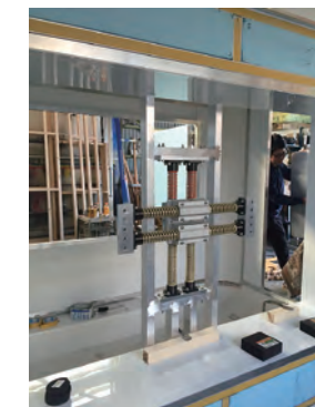
緩衝機構付モニター取り付け部（トレーラーに組み付け）
