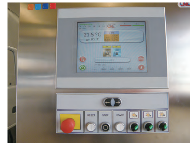
最新システムにより、乾燥温度・風量のコントロールが可能
