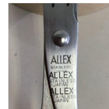
上段が従来の電解腐食、中・下段はレーザー印字装置による印字。
