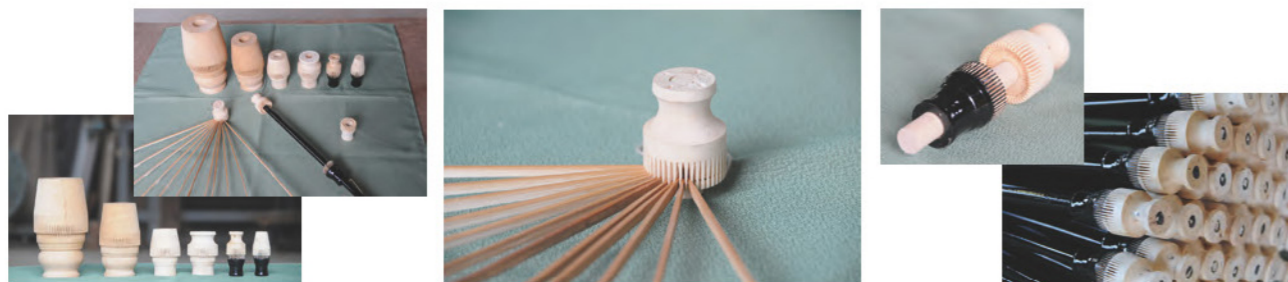
多様な傘ロクロの製造が行えるようになった 傘ロクロと骨 親骨を束ねる「頭ロクロ」と受骨を束ねる「手元ロクロ」
