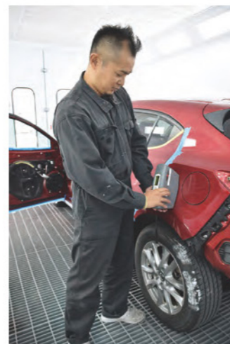
AIカメラを車体にあてただけで簡単に色を読み取れる
