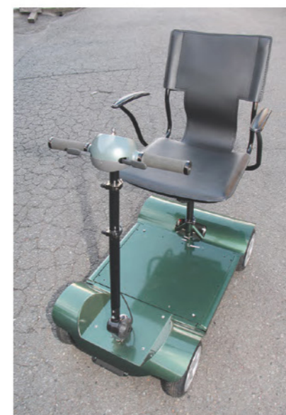
1号車の試作で得た最適寸法をベースにデザインし、下部フレームや上部フレーム（シート）を製作。2号車を完成させた
