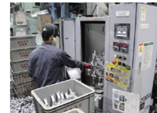
木の枝のような形のラックに部品を吊りし、回転させながらショット玉を投射するハンガー式ショット機
