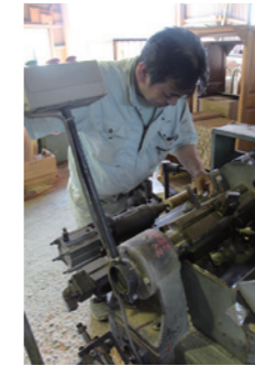
以前、メインで使っていたロット旋盤機。小さな刃物を数十枚取り付ける作業は社長しかできる人がいなかった
