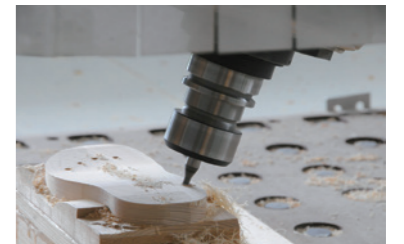
垂直、水平、傾斜の加工に対応し、下駄用台座の複雑な曲面などを効率的かつ的確に行えるようになった
