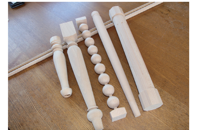
NC旋盤機で作られた丸棒。球体など、複雑な形のものでも短い時間で作れるようになった
