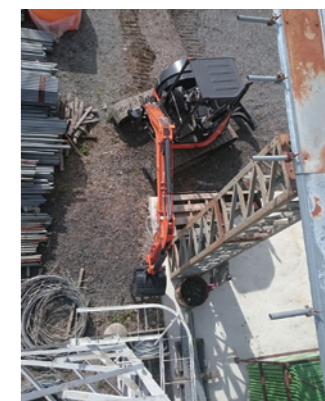
アームスイング機能を搭載し、作業制約条件が多い条件下でも効率的な作業ができる
