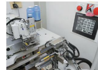
1つ山を縫製できる自動ヒダ取縫機「ヒダ取りMAX」
