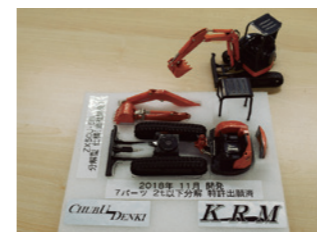
計7ユニットに分解でき、ヘリコプターで搬入可能な2トン以下を目指した
