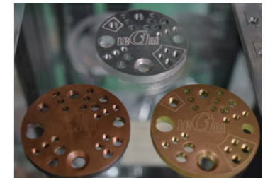
試作検証により、アルミ・銅・真鍮の加工が可能になった
