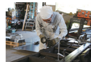
もともとは鉄製品の製造を専業で手掛けてきた。囲柱ラーメン木構造の接合に使う金物も、自社で全て手掛けている
