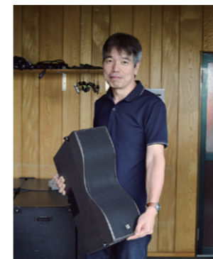
広い会場でもムラなく音を届けるラインアレー型スピーカーは、軽量で運搬や作業の効率も向上
