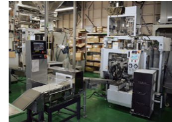
導入した小袋用全自動ガス充填包装機 HP-500
