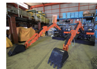
左はオプションのエクステンションアームを装着。右の標準仕様と比べ、掘削深度が1m増す
