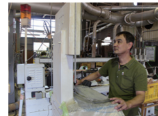
イタリアメーカー製のNC旋盤機。図面データを入力すれば、依頼の形状に自動で仕上がる
