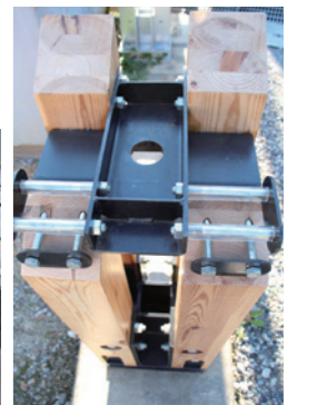
囲柱ラーメン木構造の現物を切斷したもの
