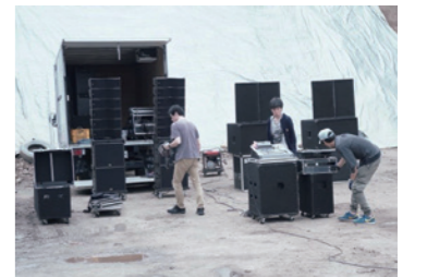
新旧のスピーカーを比較するため、野外で行った音の到達距離テスト
