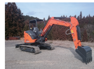
開発した分解型ミニ油圧ショベル ZX50U-5B (標準アーム装着状態)
