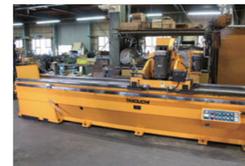
長さ3m、幅25cmのものまで研磨できる刃物研磨機「DG-W300型」
