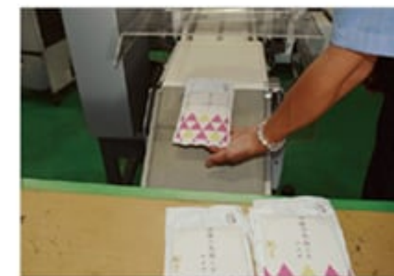
手作業では困難だった平袋の真空米も、機械化により幅・厚み共に均一な真空パックが実現
