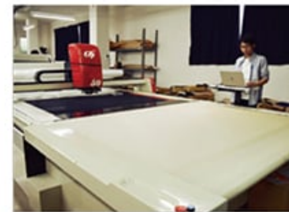
3DアパレルCADと連動し、型入れ・裁断を自動で行うCAM
