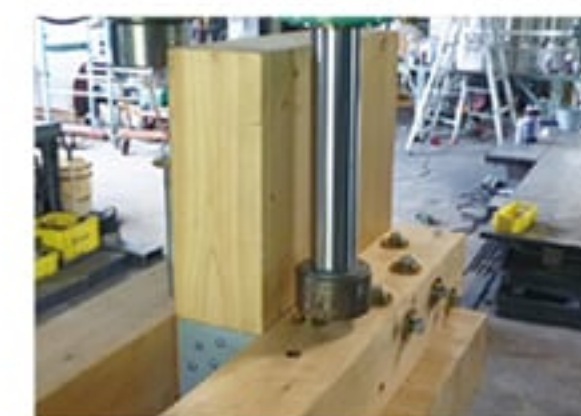
油圧挿入機の導入で、エアーツールを使用した
