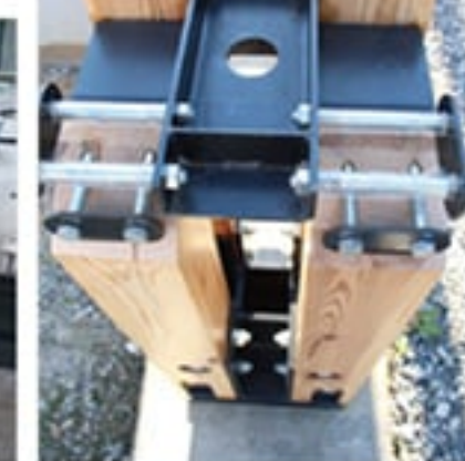
囲柱ラーメン木構造の現物を時よりも1.6倍の強度に仕上がった 切断したもの
