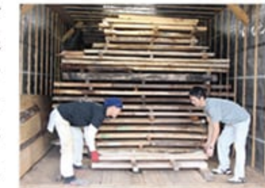
遠赤外線パネル隙間なく貼られた乾燥室。一枚板約300枚が入る
