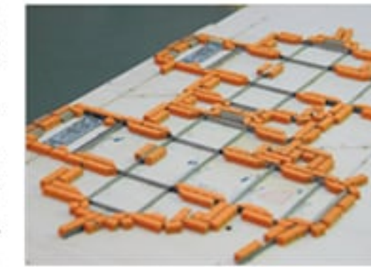
デザインに沿って製作した刃を組み込んだ木型
