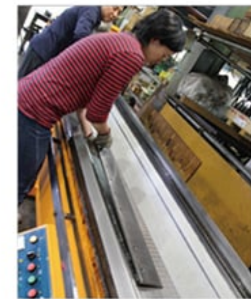
研磨するため、DG-W300型に2.5mの長尺刃物をセット。ボタンを押すと、磁力で固定される
