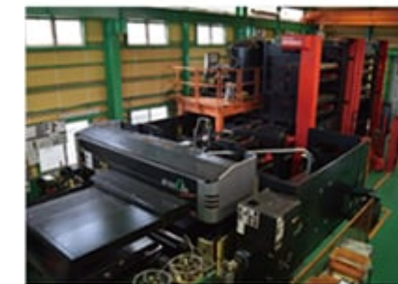
導入したパンチレーザー複合加工機 (LC2512C1-AJ)
