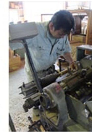
以前、メインで使っていたロット旋盤機。小さな刃物を数十枚取り付ける作業は社長しかできない人がいなかった
