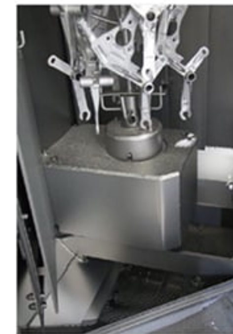
ステーションの下にある、特注のインバーター制御。インバーター制御を取り入れたことで、ステーションの回転速度を調整できるようになった
