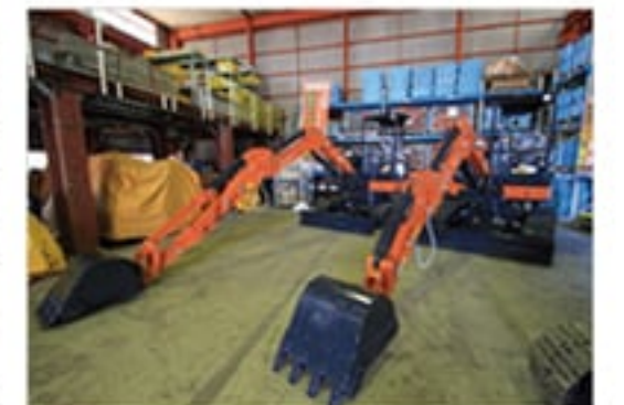
左はオプションのエクステンションアームを装着。右の標準仕様と比べ、掘削深度が1m増す
