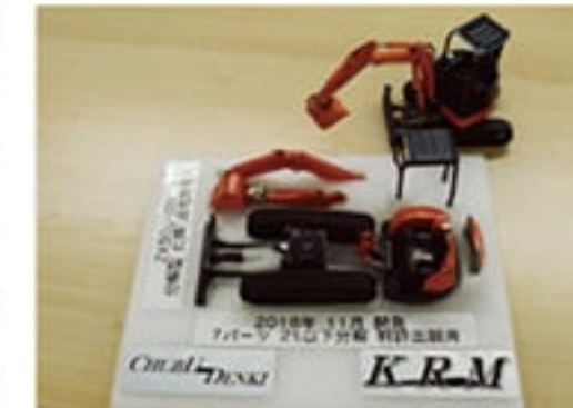
計7ユニットに分解でき、ヘリコプターで搬入可能な2トン以下を目指した
