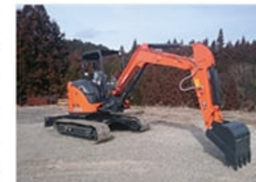
開発した分解型ミニ油圧ショベル ZX50U-5B (標準アーム装着状態)
