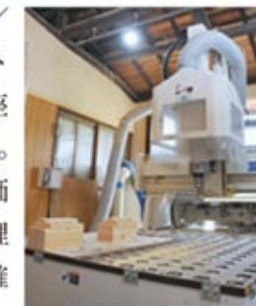
新たに導入したユニバーサルヘッド5軸制御NCマシン
