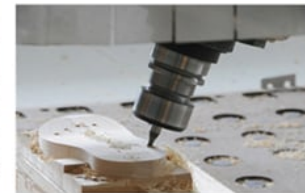
垂直、水平、傾斜の加工に対応し、下駄用台座の複雑な曲面などを効率的かつ的確に行えるようになった
