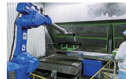
新ロボット導入により塗装品の高品質化と低コストが図られた
