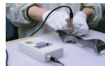
塗装性能に重要な膜厚を生産毎に測定
