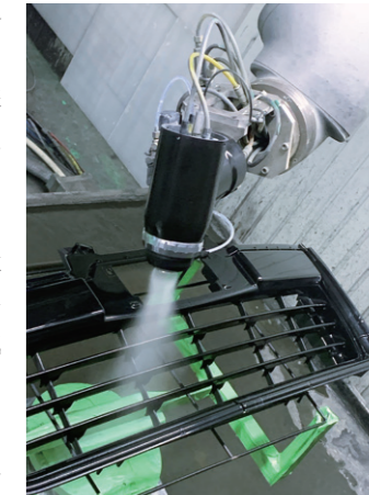
塗装ロボットに装着された高速回転霧化自動ガン
