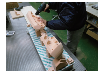
分割して製造された上下加工物の組付け作業の様子
