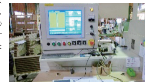
自動板取計算ソフトの導入により現場での工数削減と歩留率向上が実現
