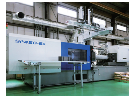
新たに導入した電動サーボ射出成型機 Si-450-6S型
