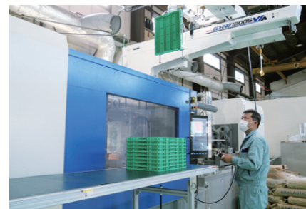
トレーの大物化・薄肉化技術を確立し、高いリブ形状にも対応した大型部品トレーの供給が可能となった
