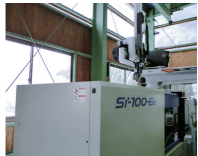
新たに導入した射出成形機・5軸取り出し機
